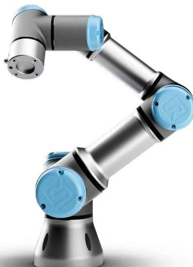
\*Der Roboter kann in einem Temperaturbereich von 0–50°C arbeiten. Bei hoher anhaltender Gelenkgeschwindigkeit wird die Umgebungstemperatur gesenkt.
