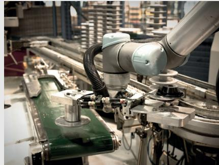
**Ergebnis:** Die Installation des UR5 senkte die Stückkosten um 10-20 Prozent und erhöhte die Kapazität um 336 Stunden pro Jahr durch eine 70-prozentige Steigerung der Bestückungsgeschwindigkeit sowie durch das schnellere Ersetzen von Maschinenteilen.
