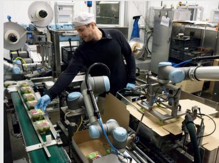
**Ergebnis:** Durch den Einsatz von Cobots hat Atria seine Verpackungsprozesse optimiert. Das Resultat: 25 Prozent weniger Materialabfall sowie eine um 5,5 Stunden verkürzte Umrüstzeit auf andere Produkte. Die Amortisationszeit betrug lediglich ein Jahr.
