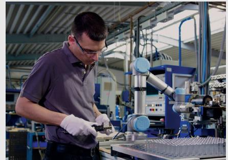
**Ergebnis:** Steigerung der Produktionskapazitäten im Anwendungsbereich um 50 Prozent durch automatisierte Bestückung von Glasdrehbänken. Die Fertigungsprozesse wurden stabilisiert und die Qualität der Produkte nachhaltig verbessert. Die Fachkräfte haben wieder mehr Zeit für Tätigkeiten der traditionellen Herstellung von Glaskomponenten.
