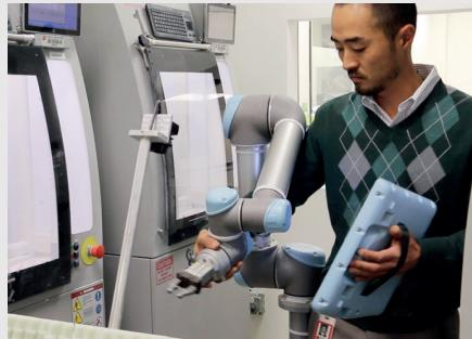
**Ergebnis:** Kürzerer Produktionszyklus beim Fräsen von Dentalkronen durch automatisierte Bestückung von CNC-Maschinen: Die Produktionszeit wurde um neun Stunden (von 27 auf 18 Stunden) gesenkt und die Produktqualität gleichzeitig erhöht.
