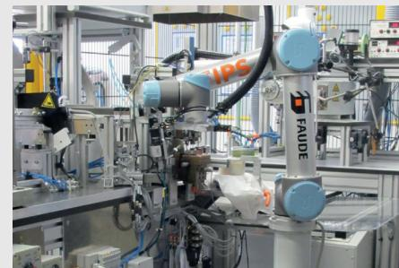
**Ergebnis:** In dem Setup mit zwei UR-Robotern werden die Qualität der Löt- und Schweißarbeiten von rund 160 Teilen pro Stunde automatisch überprüft. Damit erhöhte Ferdinand Wagner Profile seine Produktivität und erreichte gleichzeitig sein Ziel der Kostenstabilität.
