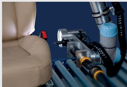
**Ergebnis:** Der globale Automobilzulieferer hat seine Just-in-time-Montage durch die Einführung moderner Robotertechnologie optimiert. Der Cobot führt jeden Tag rund 8.500 Verschraubungen in Autositzen durch und überwacht den Prozess digital, um defekte Sitze auf dem Förderband auszusortieren. Das zahlt sich in höherer Produktionsgeschwindigkeit und verbesselter Produktqualität aus.
