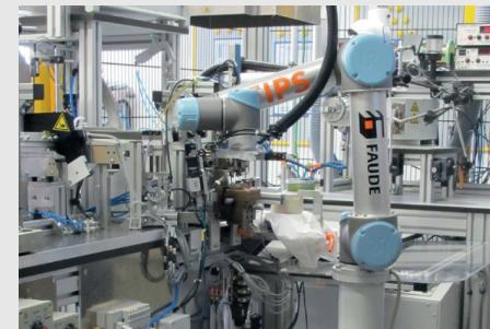
**Ergebnis:** In dem Setup mit zwei UR-Robotern werden die Qualität der Lötz- und Schweißarbeiten von rund 160 Teilen pro Stunde automatisch überprüft. Damit produziert Ferdinand Wagner Profile rund um die Uhr ohne Unterbrechungen und erreicht gleichzeitig sein Ziel der Kostenstabilität.
