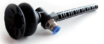
Eine Tragfähigkeit von 3,3 kg bei 80 % Vakuum mit zweifacher Sicherheit bietet Ihnen dieser runde Balgsauggreifer. Er hat 1,5 Falten und einen Durchmesser von 40 mm. Das Saugermaterial besteht aus NBR.
