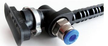
Für flache und längliche Werkstücke eignet sich dieser Flachsauger mit ovaler Form. Er hat eine Stützfläche an der Unterseite und eine Zweiohrklemme gegen unbeabsichtigtes Verdrehen. Das Saugermaterial besteht aus NBR. Maße: 45 x 15 mm.
