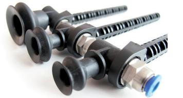
An gewölbte Flächen passt sich der runde Balgsauggreifer mit 1,5 Falten sehr gut an. Er hat zusätzlich einen hervorragenden Dämpfereffekt. Auch bei großer Beschleunigung bleibt er formbeständig. Das Saugermaterial besteht aus NBR und ist auch in Silikon oder Naturkautschuk lieferbar. Der Durchmesser ist variabel, von 16 mm über 20 mm bis 33 mm.
