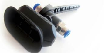
Schmale und zylindrische Teile und Rohre mit einem Durchmesser von 25 mm hebt dieser ovale Balgsauggreifer mit 1,5 Falten. Die Tragfähigkeit beträgt 3,4 kg bei 80 % Vakuum mit zweifacher Sicherheit. Das Saugermaterial besteht aus NBR. Maße: 25 x 50 mm.
